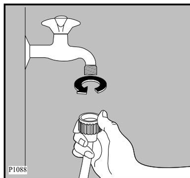
am Gerät und am Wasserhahn auf Dichtigkeit prüfen!
